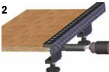
Fissare il sistema sull'altro pannello, settare i perni di arresto e posizionare la profondità di foratura. Eseguire le forature orizzontali.
