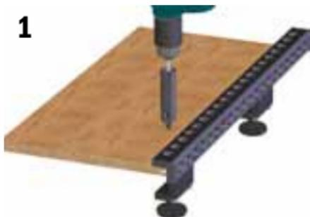
Posizionare il sistema di foratura sul pannello, settare i finecorsa e serrare il pezzo. Posizionare la profondità di foratura e serrare la punta all'adattatore che va montato sul trapano. Eseguire le forature verticali.
