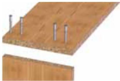
Oppure usate punte per fori passanti per giunzioni a mezzo di viti autofilettanti.
